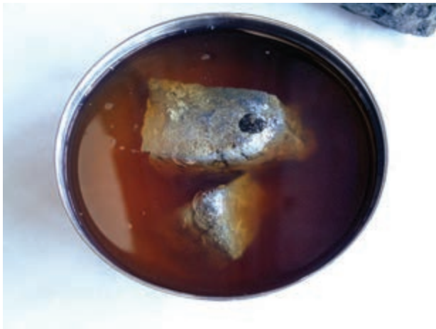
شکل ۱۲-۲- نگهداری کاربید در زیر نفت
