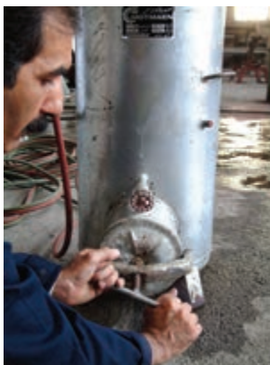
شکل ۲-۳۶- بستن دریچه‌ی محفظه‌ی کاربرد
