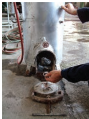
شکل ۲-۳۴- قرار دادن کاربرد در محفظه‌ی مخصوص
