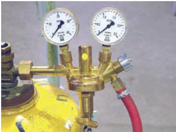
شکل ۱۳۵-۲- پیچ تنظیم فشار استیلن روی رگولاتور
