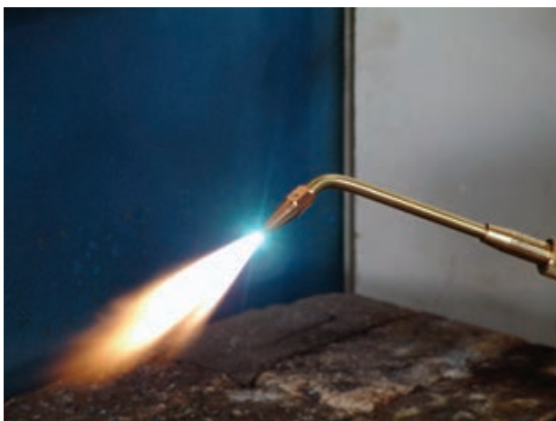
شکل ۲-۳- شعله‌ی سوختن گاز استیلن با اکسیژن
