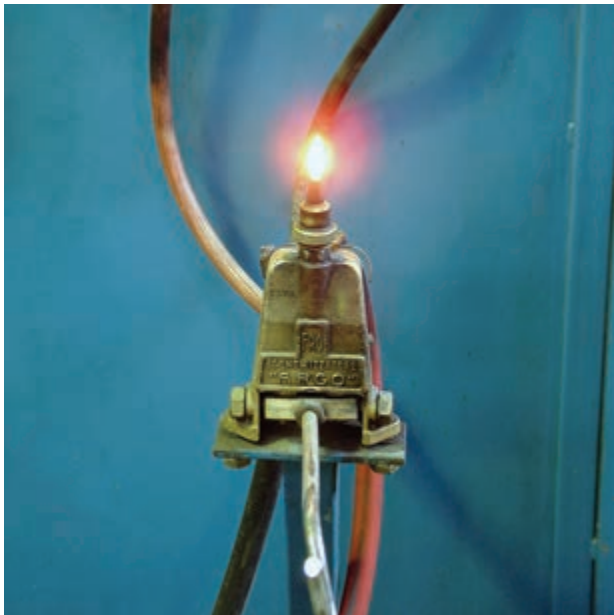
شکل ۲-۶۸- شمعک روی میز جوشکاری گاز
